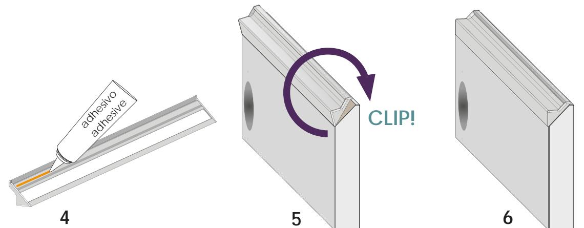
La gama tiradores de perfil Syma se instalan mediante el CLIP-SYSTEM. Sin mecanizaciones
