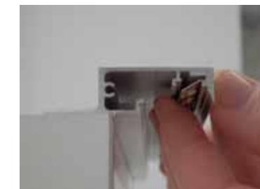
Colocamos la tira LED mediante presión.
