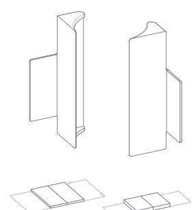
Le set d'équerres rincomatic-syma représente une solution pour couvrir les ouvertures laissées par les poignées profilées dans l'angle
