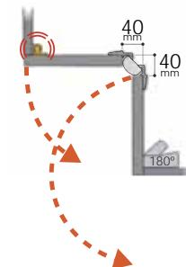
Rincoplus occupe 40mm dans des angles à 90°, indépendamment de l'épaisseur des portes. Elle fonctionne parfaitement pour tout meuble d'angle supérieur à 75°
