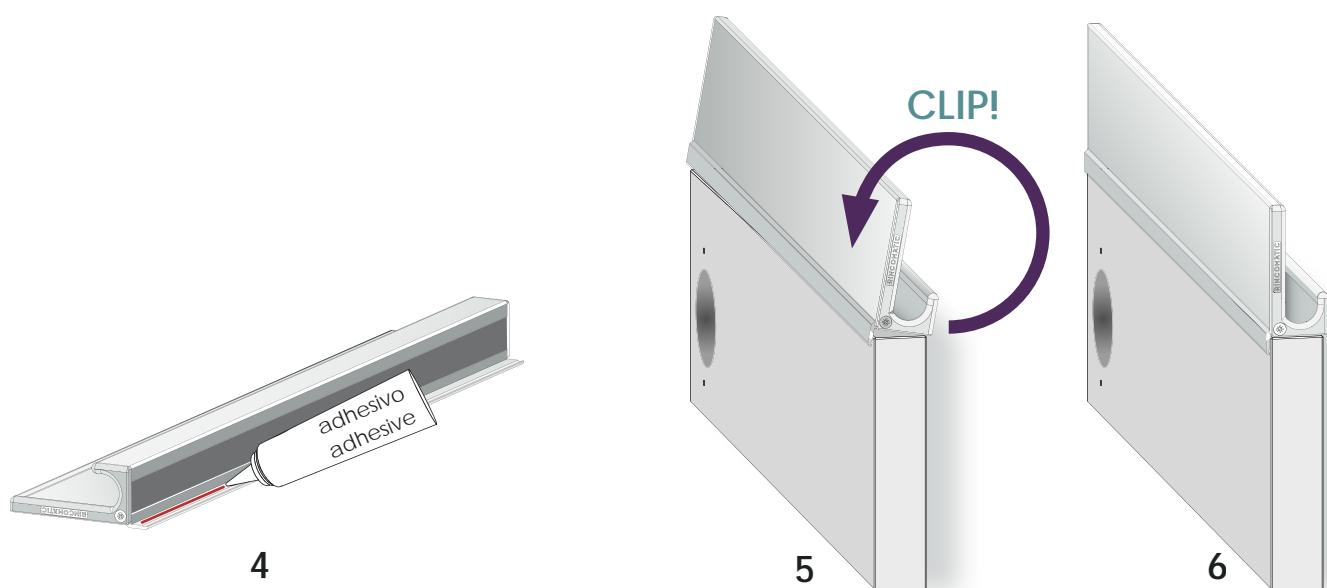
La gama tiradores de perfil Syma se instalan mediante el CLIP-SYSTEM. Sin mecanizaciones
