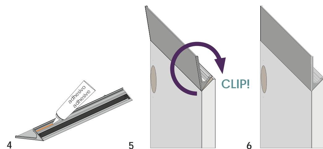
La gama tiradores de perfil Syma se instalan mediante el CLIP-SYSTEM. Sin mecanizaciones
